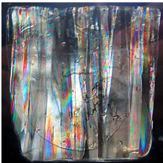
Isens kristallmönster framträder om man håller en tunn isskiva mellan två korslagda polariserande filter. Denna is är 7 cm tjock och har smala stavformade kristaller. Till vänster isen från sidan (naturlig storlek); till höger isens undersida (något förstord). Is från Yngern, Sörmland, 6 januari 2005. Foto: Johan Porsby
