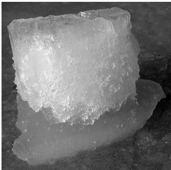
En tunn stöpisskorpa med rutten kärnis under (Isprovet på bilden är vänt upphöjning). Mellan islagren fanns ett par centimeter med vatten. Sådan is är mycket osäker. Åbo skärgård, 28 mars 2004. Foto: Johan Porsby
