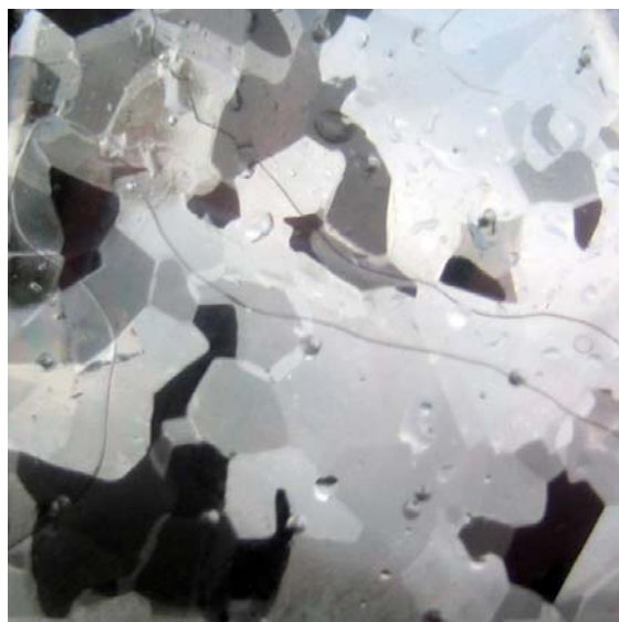
Isens kristallmönster framträder om man håller en tunn isskiva mellan två korslagda polariserande filter. Denna is är 7 cm tjock och har smala stavformade kristaller. Till vänster isen från sidan (naturlig storlek); till höger isens undersida (något förstord). Is från Yngern, Sörmland, 6 januari 2005. Foto: Johan Porsby
